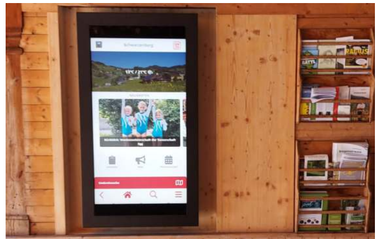
Gemeinde Schwarzenberg 46 Zoll Hochformat Außenmonitor als Wandmontage in Holzkonstruktion eingebaut
