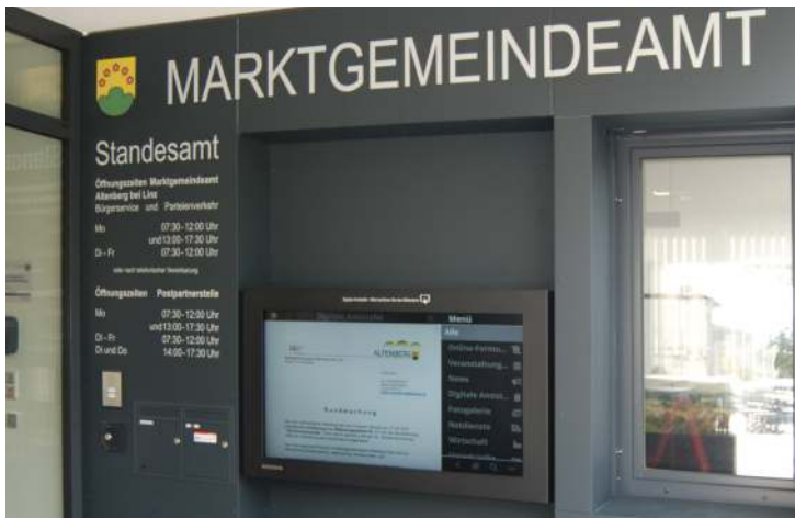
Marktgemeinde Altenberg 55 Zoll Querformat Außenmonitor Sonderlösung integriert in Alu-Unterkonstruktion mit beschichteter Verblendung
